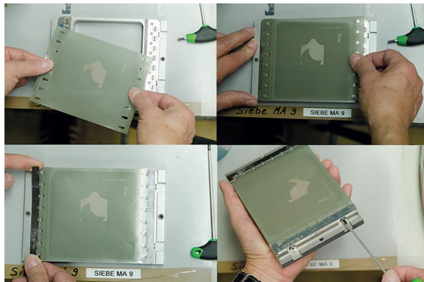
Das Screeny-G-Line-Prinzip: Mit wenigen Handgriffen sind die bebilderten Siebdruckplatten im Rahmen eingespannt.
